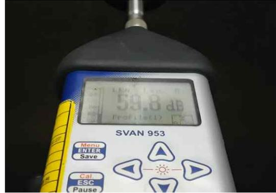
(d) 소음 측정(설치 전, Down)
