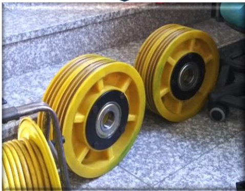
승강기 카 상부 쪽 "분할 독립 로프폴리" 설치 예(L타입)
