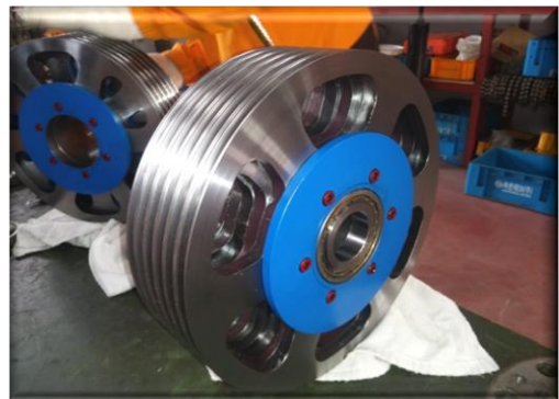
승강기 카 상부 쪽 "분할 독립 로프폴리" 설치 예(L타입)
